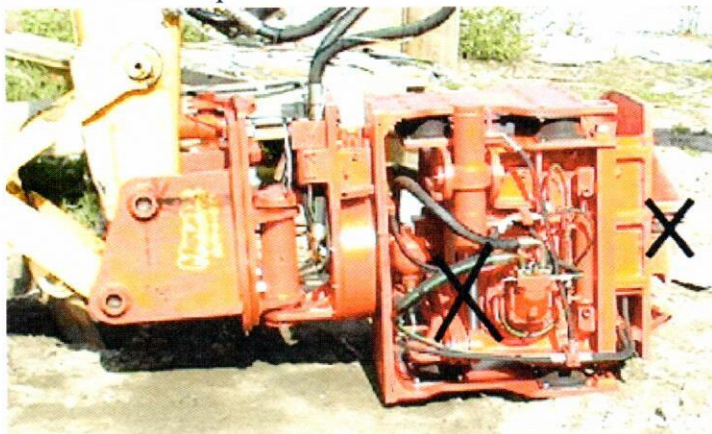
Рис. 33. В транспортном положении захваты должны быть открыты.
