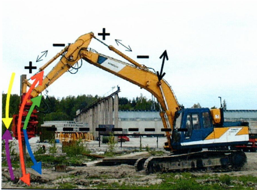
Рис. 25. Возможные траектории движения вибропогружателя Movax
