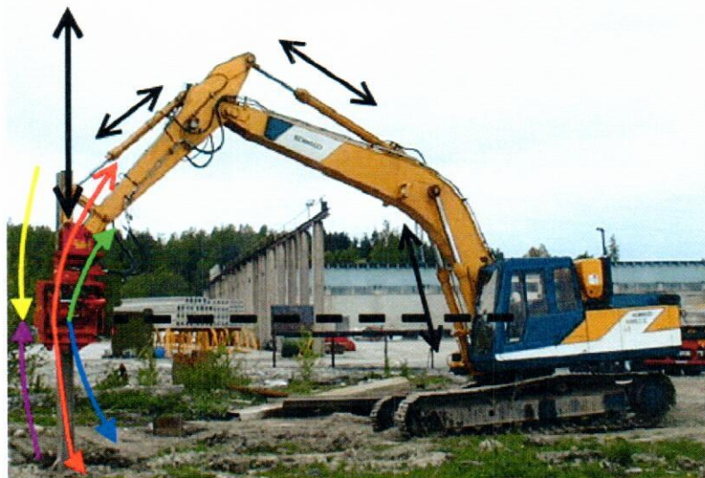
Рис. 26. Траектории движения Мовахи стрелы экскаватора
