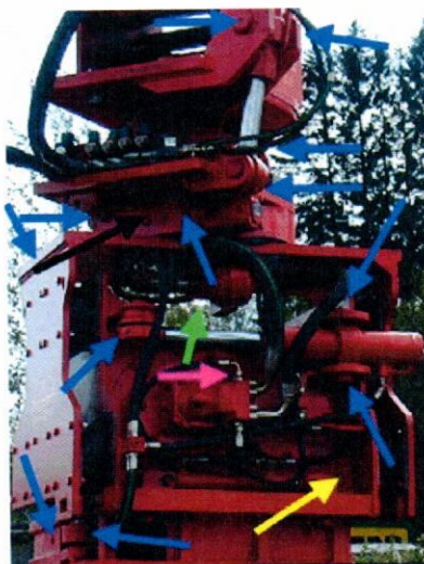
Рис. 28. Точки смазки, заливное и сливное отверстия
